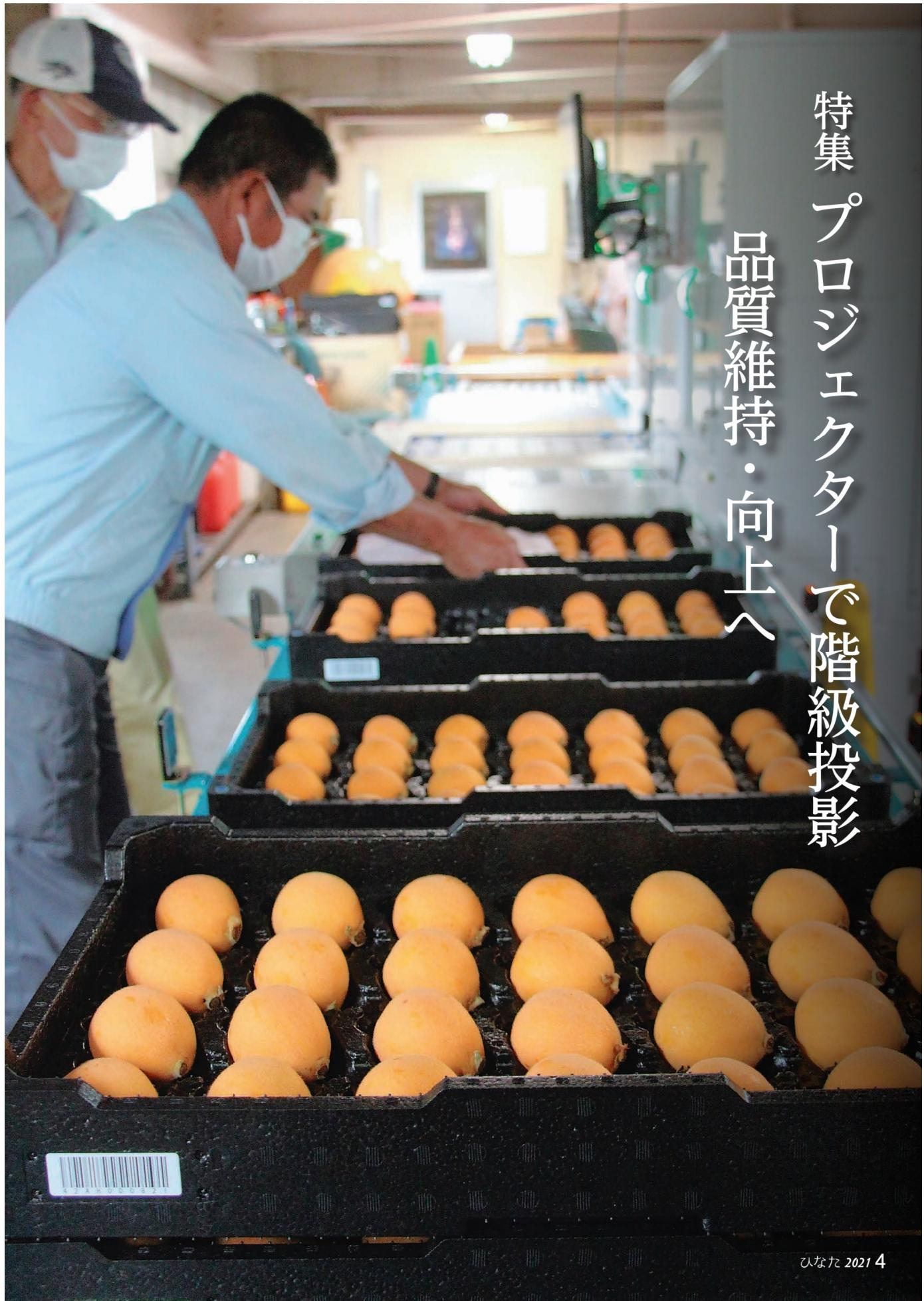
J A長崎せいひは、映像を立体的に投影する「プロジェクトショットマッピング」の技術を用いた新たな選果機を5月上旬から川原集出荷場で稼働しています。選果の精度と品質維持・向上を目指し、生産者の所得向上につなげます。びわに投影された階級などは、画面を光の文字で果実に投影し、画面
