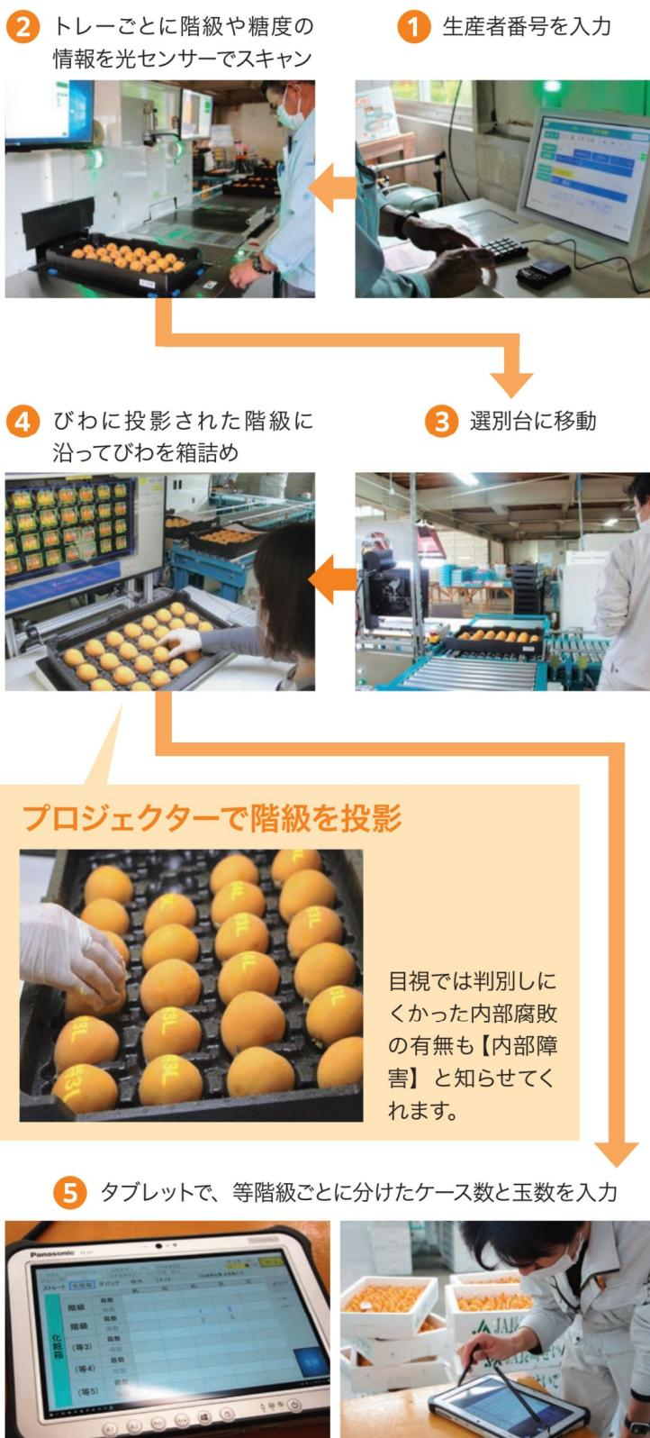
にも表示。内部腐敗の有無も分かれます。目視で分ける手間が大幅に軽減され、誰でも作業を担えるため、人手不足に対応できます。プロジェクトショットマッピングは、主にイベントの演出などで建物を光で彩るのに使われていますが、JAが導入した選果機では、エッグス線や近赤外線光で果実の重量、
